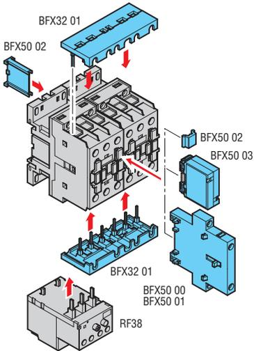
Conexiones para arrancadores estrella-triángulo con contactores BF09...BF25
