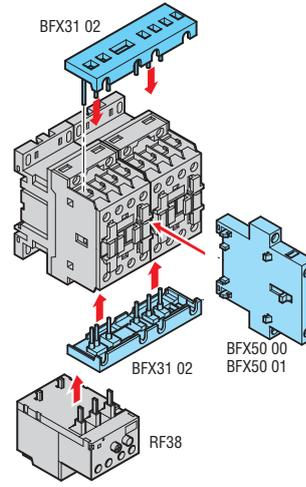
Conexiones para arrancadores teleinversores con contactores BF26...BF38
