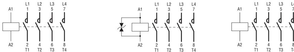
**CONTACTORES TETRAPOLARES EN AC CON 2 POLOS NA Y 2 POLOS NC**
