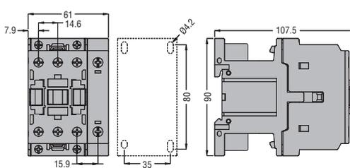
**BF40 00E... - BF50 00E... - BF65 00E... - BF80 00E...** tripolares con relé térmico RF82
