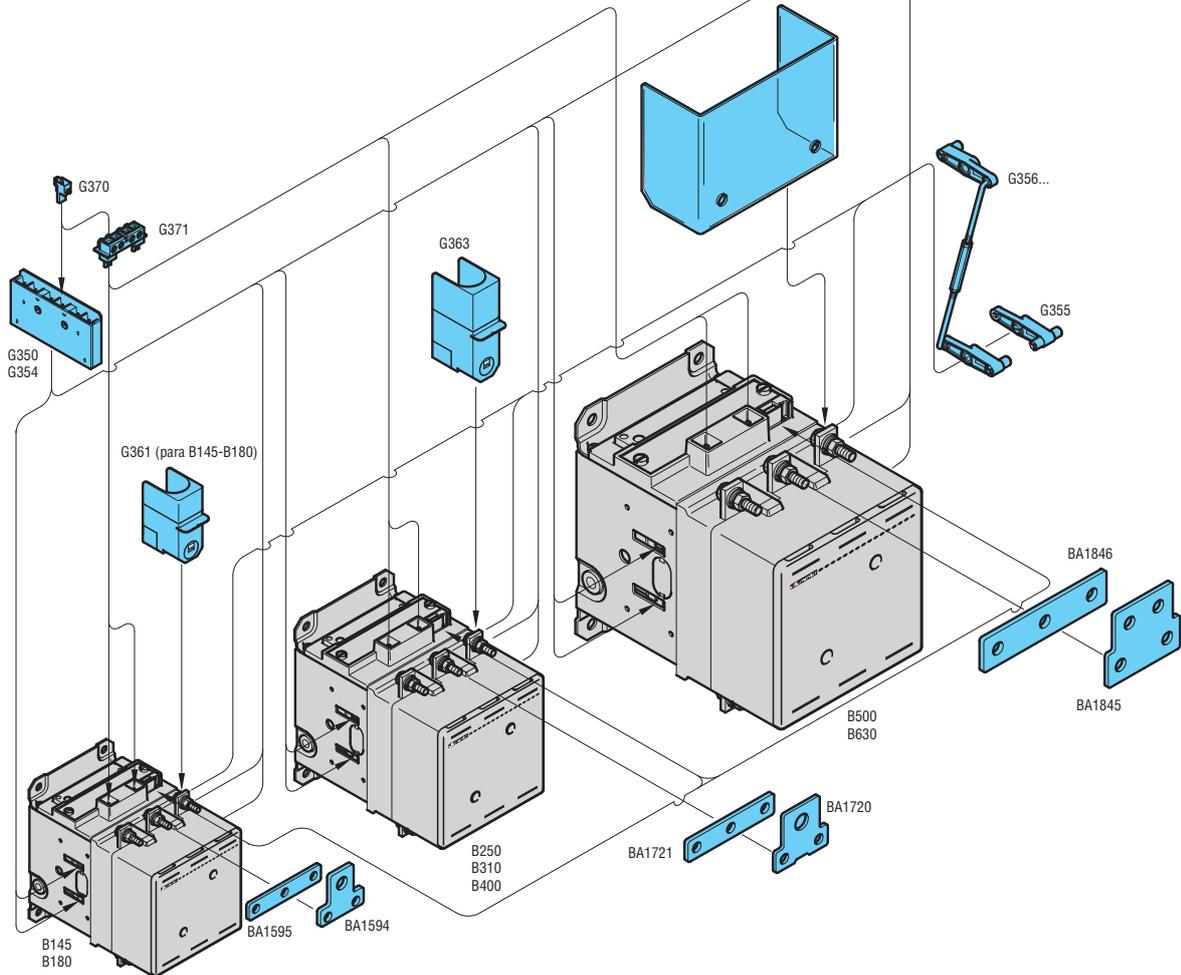
Los contactos auxiliares adicionales tipo G350 y G354 pueden aplicarse a los contactores B145...B630 1000 hasta un máximo de 4 bloques por contactor (total máximo de 12 contactos).
