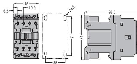
**BF26... - BF32... - BF38... D y L** tripolares con relé térmico **RF...38**
