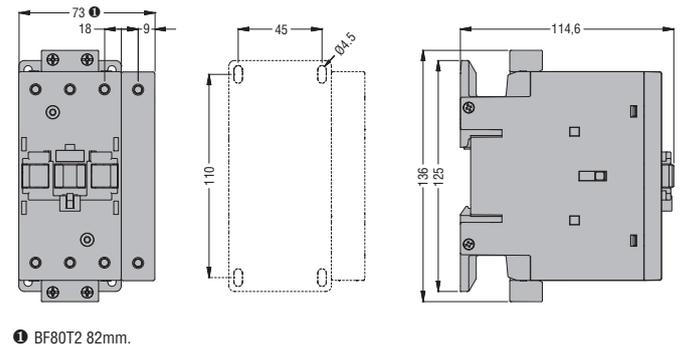
**BF85 00E... - BF95 00E... - BF115 00E... - BF150 00E...** tripolares con relé térmico RF110
