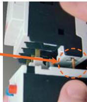
Mientras el relé térmico se fija al contactor, el contacto auxiliar se conecta al terminal de la bobina del contactor mediante un terminal rígido. Con una única operación se obtiene la fijación completa del relé, sin necesidad de otras conexiones.
