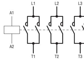
❶ El circuito electrónico de la bobina ha sido diseñado y probado según la norma IEEEC 62.41 y puede soportar un pulso de tensión de 10kV(1,2/50µs). Para valores superiores se aconseja alimentar la bobina mediante un transformador auxiliar.
