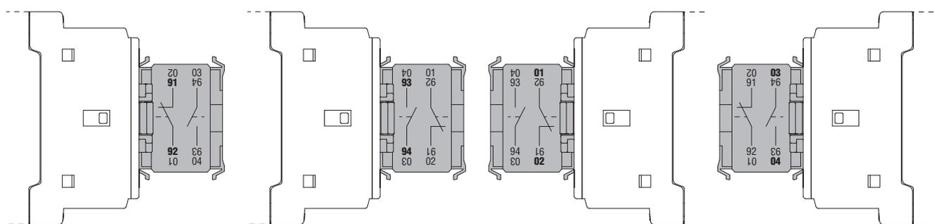
El contacto auxiliar G218 tiene varias numeraciones, dado que pueden asumir diversas posiciones de montaje. Para una correcta interpretación, tómense como referencia los números destacados en negrita.
