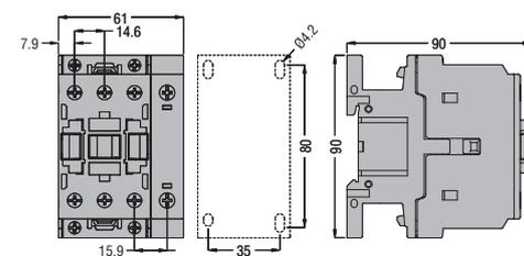
**BF40 00A...** - **BF50 00A...** - **BF65 00A...** - **BF80 00A...** tripolares con relé térmico **RF82**
