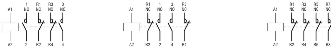
**CONTACTORES TETRAPOLARES EN DC (AC/DC para BF80T2E) CON 2 POLOS NA Y 2 POLOS NC**
