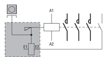
Los contactos auxiliares BFX12... / G418... / G481... / G482 tienen varias numeraciones, dado que pueden asumir diversas posiciones de montaje. Para una correcta interpretación, tómonse como referencia los números destacados en negrita cuando el bloque se monta del lado izquierdo del contactor.
