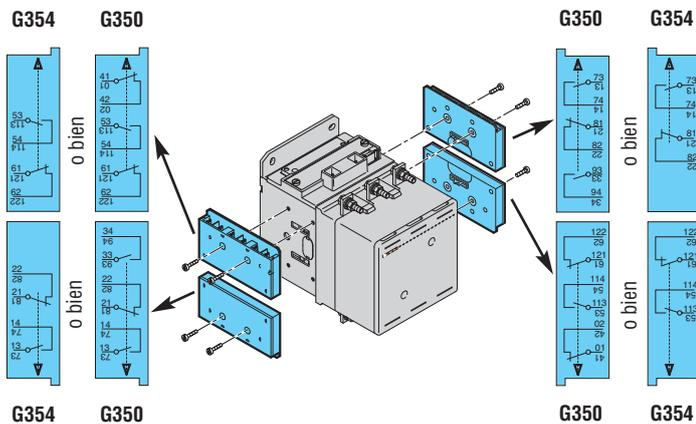
Con el adaptador G358 pueden montarse los contactos auxiliares tipo BFX10... de 2 contactos y G484..., así como los contactos auxiliares temporizados G485..., G486..., y G487 (tipos y códigos en la pág. 2-18).
