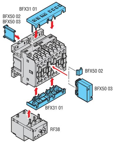
Conexiones para arrancadores teleinversores con contactores BF09...BF25 y enclavamiento mecánico BFX50 00 o BFX50 01
